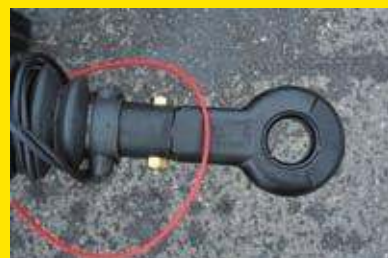
DIN-vlečna kljuka za tovornjake in po višini nastavljivo ojnico
