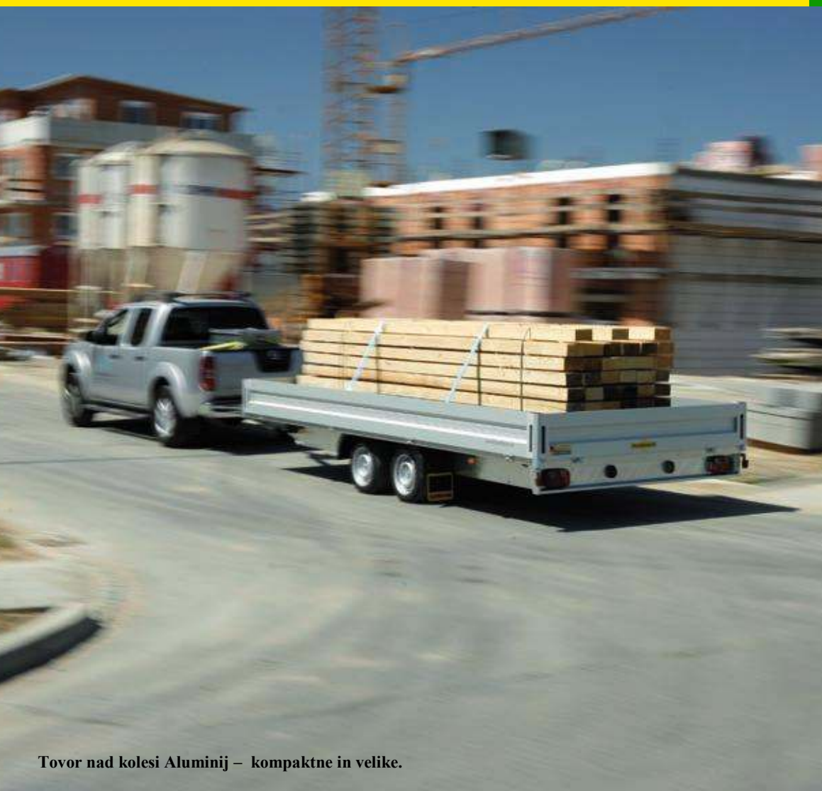
Masiven okvir iz aluminija zapojenega jeklenega profila s prečnimi ojačami toplo pocinkano.
