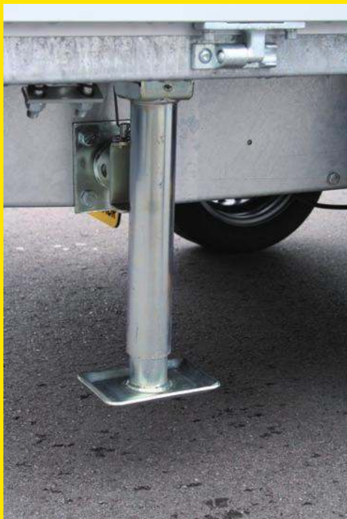
Teleskopski opornik z vitlo, za oporo pri nakladu z navoznimi kolesnicami (rampami)
