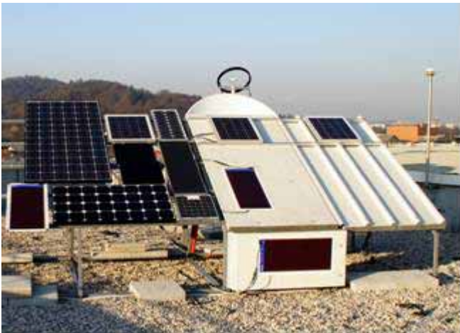
Slika 11: Preizkuševališče PV modulov na strehi UL FE za različne načine postavitve
