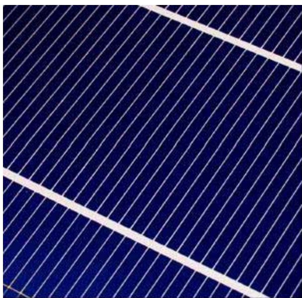
Slika 20: Zgornja površina kristalne silicijeve sončne celice z značilno temno modro barvo.
