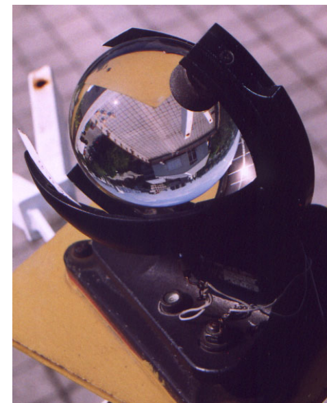
Heliograf: optična naprava za merjenje trajanja sončnega obsevanja
