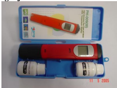
slika 22: pH meter v kompletu s pufrom 4,0 in 7,0 Za znižanje pH vrednosti mešanice, s katero boste škropili, uporabite pripravek VYRER (slika 23), poraba 10-120ml/100 l vode
