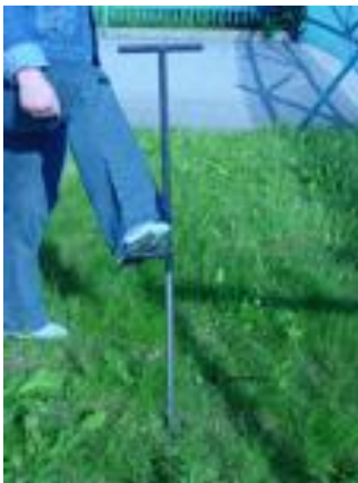
slika 1: sonda za jemanje vzorcev tal
