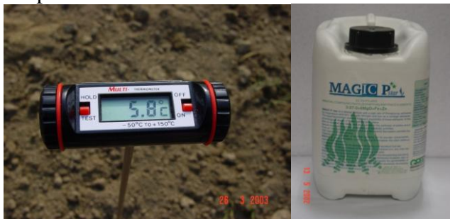
Slika 8: digitalni termometer za merjenje temperature tal
