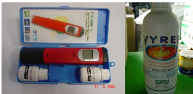
slika 11: pH meter v kompletu s pufrom 4,0 in 7,0 Za znižanje pH vrednosti mešanice, s katero boste škropili, uporabite pripravek VYRER (slika 12), poraba 10-120ml/100 l vode
