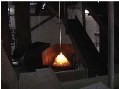
Slika 2. Potek ogrevanja jeklenega valja v indukcijski peči in ohlajanje raztaljenega stekla lahko zaradi visokih temperatur grobo ocenimo tudi s prostim očesom [2]
