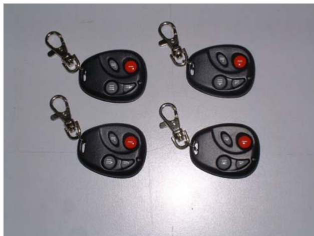
Elementi sistema KEELOQ (krmilnik/RX, TX roll-code)
