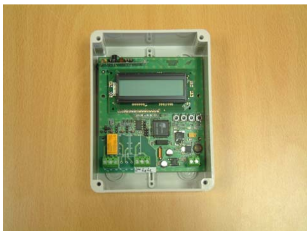
Elementi sistema KEELOQ (krmilnik/RX, TX roll-code)
